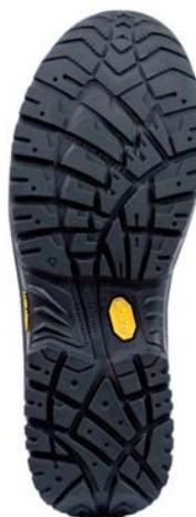
Suola con spunterbo antiusura. Battistrada in gomma Vibram® resistente a 300° C per contatto (HRO), agli acidi e oli. Disegno della battistrada autopulente, con Standard Antislip SRC.
