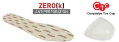
Puntale in materiale plastico, ultraleggero resistente all'urto di oltre 200J, elastico. Atermico. Non rilevabile al metal detector. Lamina antiperforazione tessuta. Resistente a più di 1100 N a perforazione zero.
