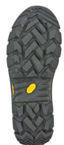
Suola con spunterbo antiusura. Battistrada in gomma Vibram® resistente a 300° C per contatto (HRO), agli acidi e oli. Disegno della battistrada autopulente, con Standard Antislip SRC.
