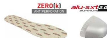
Nuovo puntale con gommino, in alluminio a spessori variabili funzionali. Resistente all'urto oltre 200joule. Lamina antiperforazione tessuta.resistente a più di 1100 N a perforazione zero
